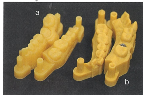
図13 レジン液をかき混ぜなかった場合の模型 (a) とよくかき混ぜた場合の模型 (b)
